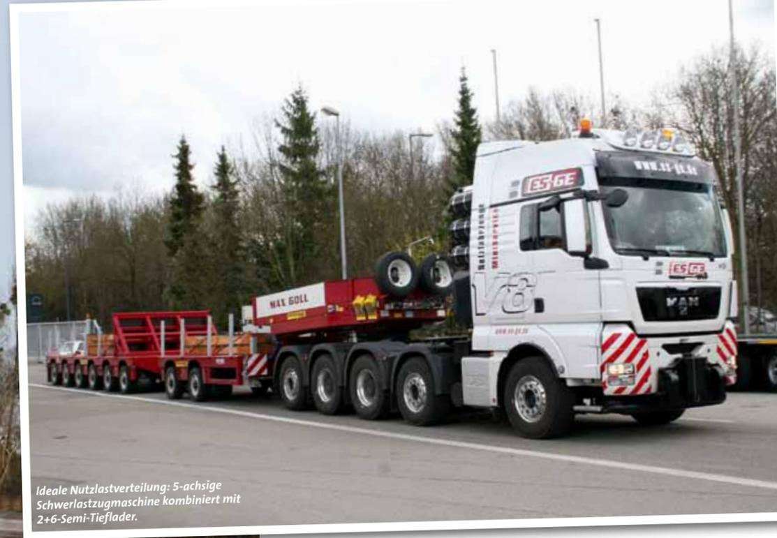
Ideale Nutzlastverteilung: 5-achsige Schwerlastzugmaschine kombiniert mit 2+6-Semi-Tiefloader.
