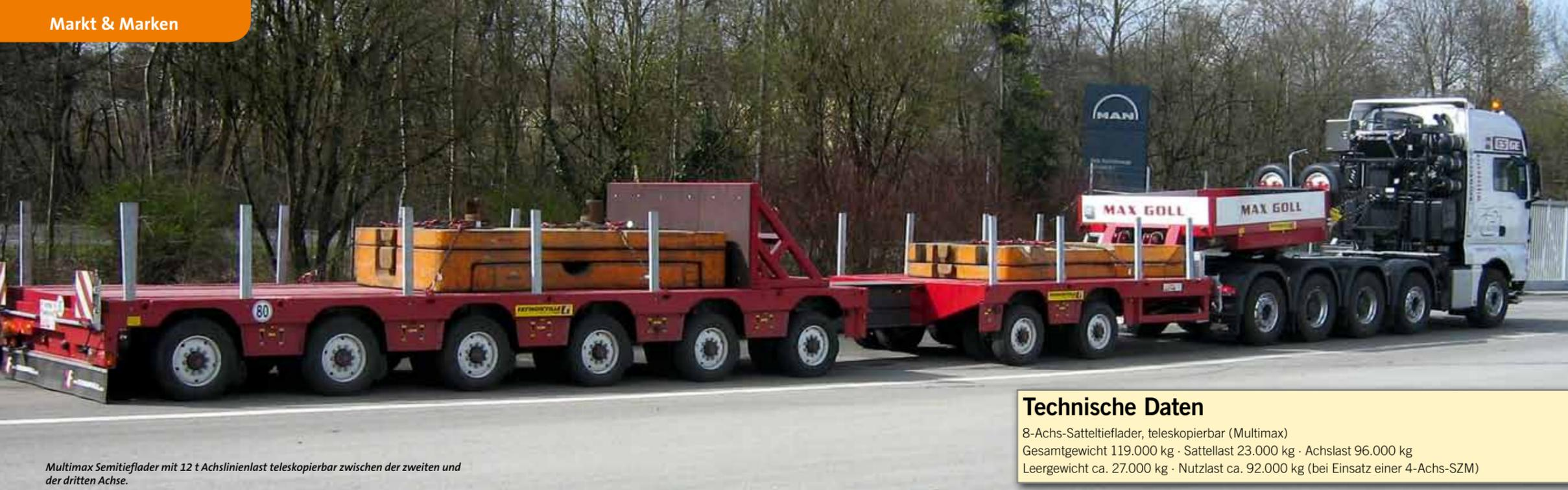
Multimax Semitiefelader mit 12 t Achslinienlast teleskopierbar zwischen der zweiten und der dritten Achse.
