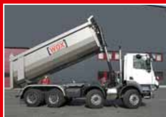
4-Achs-Lkw mit Hardox-Hinterkipplmulde.
