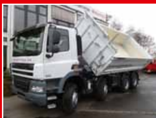
8x4 DAF FAD CF 85.410 mit Meiller-Drei-Seiten-Kipper, Ladevolumen: 13,3 m 3 .
