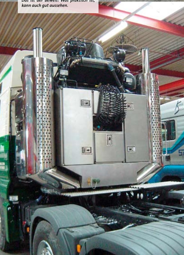
Eine unlängst ausgelieferte Maschine dieses Typs bringt es immerhin auf ein technisch mögliches Gesamtgewicht von 48 t, verteilt auf 2 x 9 t für die Vorderachsen, 10 t auf die Vordachachse und 2 x 10 t auf den Hinterachsen. Zugelassen ist die Maschine aktuell auf 44
